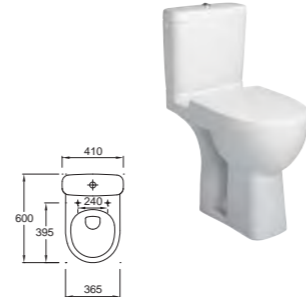
18557К-00 NF Чаша унитаза с горизонтальным сливом (60 x 36,5 см), высота сидения 43 см. E4740-00 Бачок с нижней подавкой воды, оснащенный механизм экономии воды 3/6 л. E70011-00 Съемная крышка-сиденье с механизмом «плавное опускание» с металлическими креплениями
