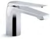
E97345-CP Однорычажный смеситель для умывальника с гибкой подводкой. Высота под изливом 92 мм. Донный клапан. Максимальный расход воды 5 л/мин. E97345-ND-CP Без донного клапана
