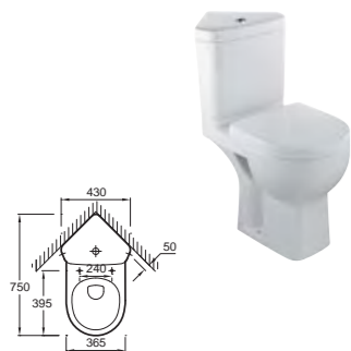
18557К-00 NF Чаша унитаза с горизонтальным сливом (60 x 36,5 см), высота сидения 43 см. E4741-00 Угловой бачок с нижней подавкой, оснащенный механизм экономии воды на 3/6 л
