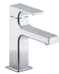
E37333-CP Кран холодной воды для раковины. Керамические кран-буксы на 1/4 оборота. Без донного клапана. Расход воды 5 л/мин
