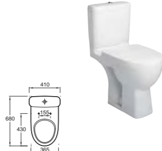
4966СК-00 NF Унитаз с горизонтальным выпуском (68 x 36,5 см), высота чаши 45 см, функциональность 4 или 6 л. E4740-00 Бачок с нижней подавкой воды, оснащенный механизм экономии воды 3/6 л. Подходит к унитазам 4956СК и 18557К 8409К-00 Съемная крышка-сиденье из термодюра с механизмом «плавное опускание» и креплениями из нержавеющей стали.
