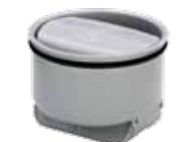
Сухой затвор для трапов Viega (мод.583255), «Сухой» затвор устанавливается в горловину трапа. Предотвращает попадание запаха из канализации в помещение при высыхании водяного столба в гидрозатворе (в случае редкого использования душевой).
