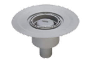
Трап Advantix VIEGA (мод.4935.1/557119), горизонтальный выход D50, Пропускная способность – 0,6 л/с.
