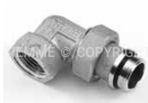
1565NR Raccordo curvo tre pezzi nichelato con O-RING e pretenuta sul filetto maschio Nickel-plated 3 pieces elbow with O-RING and pre-sealed male thread
