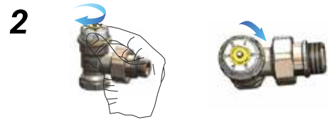
2 Ruotare la manopola numerata finché il numero corrispondente al Kv desiderato (vedi tabella sotto riportata), è allineato all'incisione di riferimento presente sul corpo valvola. Rotate the numbered knob until the number corresponding to the required Kv value (see table below) is aligned with the reference notch on the valve body.
