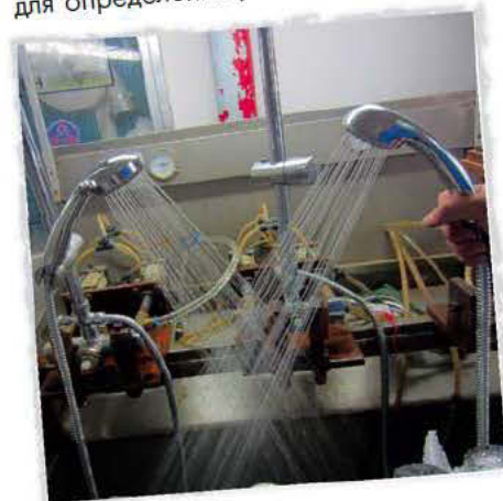
Стенд гидравлических испытаний для определения радиуса факела душа
